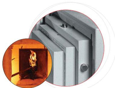
En caso de incendio las juntas se dilatan hasta alcanzar 10 veces su volumen para asegurar una perfecta estanqueidad al calor, a las llamas, al gas, al sistema de aspersión.
