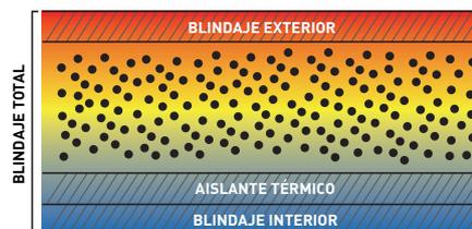
En un cofre sin aislante la temperatura aumenta rápidamente en caso de incendio. Con los cofres MB sus documentos estarán mejor protegidos. El aumento de la temperatura interna se ralentiza de manera considerable gracias a los materiales ignífugos con certificación Alemana DIN 4102.
