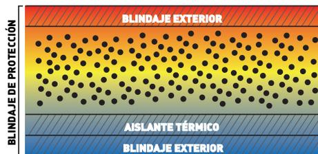
En una caja fuerte sin aislante la temperatura aumenta rápidamente en caso de incendio. Con las cajas fuertes MB sus documentos estarán mejor protegidos. El aumento de la temperatura interna se ralentiza de manera considerable gracias a los materiales ignífugos con certificación Alemana DIN 4102.
