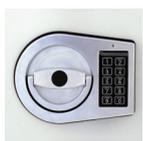
Cerradura Electrónica con certificación según la norma Europea ENV 1300 grado 2 VDS. 1 millón de combinaciones posibles, 1 código maestro y 1 código de usuario programables. Sistema alimentado por una pila de 9V accesible desde el exterior.
