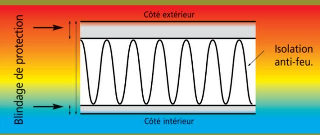
Isolation anti-feu norme allemande DIN 4102 : pour protéger vos armes et vos documents contre le feu, l'espace entre les parois est garni d'un matériau ignifuge qui résiste à de hautes températures. Le joint anti-feu placé autour de la porte se dilate 10 fois en cas d'incendie pour coller à la paroi du coffre et assurer une protection contre les flammes, les gaz, la chaleur et l'eau.
